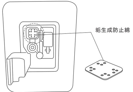
※垢生成防止綿は本体内部の底面に1個取り付けられています。
