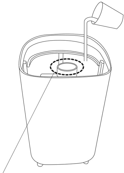
※この部分はミストの吹き出し口ですので絶対に水道水を入れないようにして下さい。故障の原因となります。
